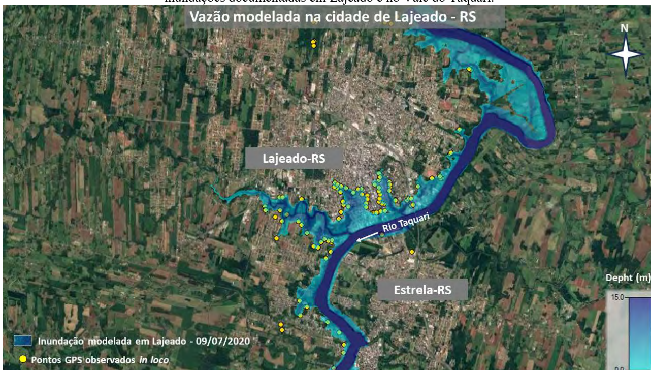
Figura 11 - Mancha simulada da inundação de 09 de julho de 2020, que alcançou o nível topográfico ajustado de 26,69 m (GREINER, 2014) em Lajeado, com o ajuste dos pontos de validação de campo, representando uma das maiores inundações documentadas em Lajeado e no Vale do Taquari.
