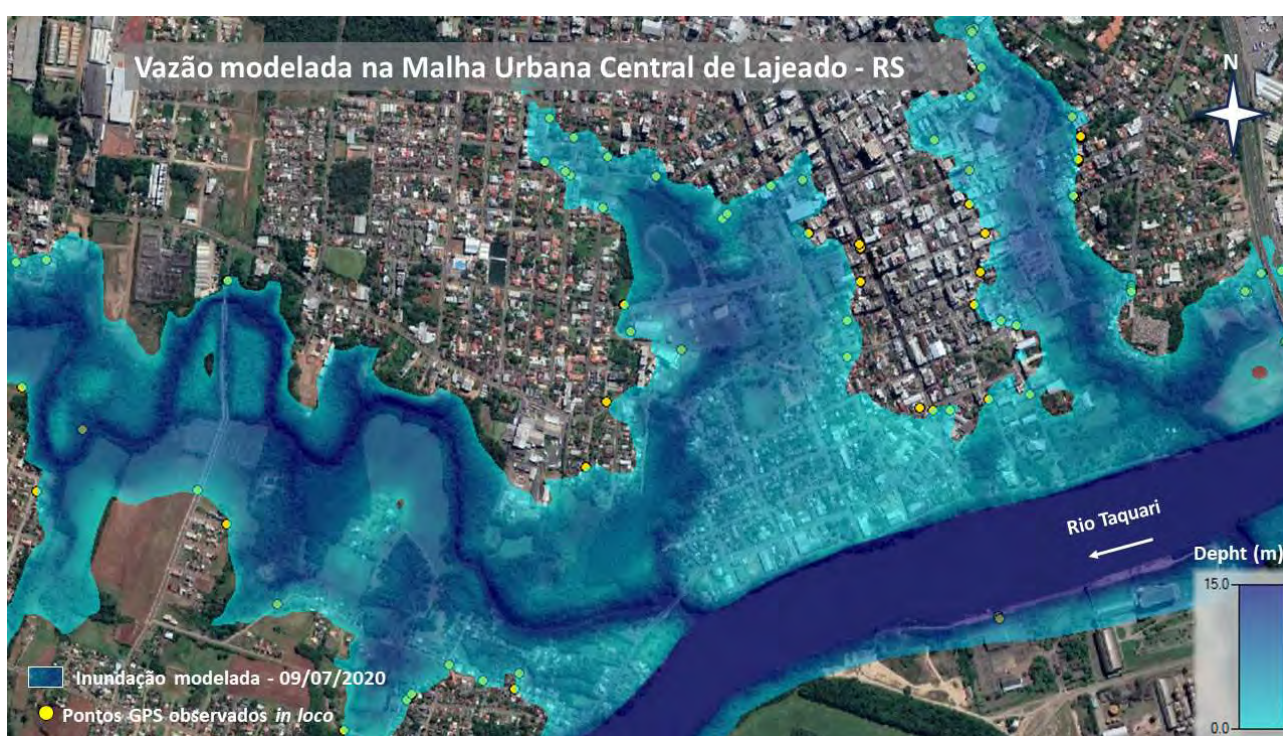
Figura 10 - Modelagem hidrodinâmica e propagação das vazões da inundação de 09 de julho de 2020 no HEC-RAS para Lajeado, a partir de uma vazão de input de 18.100 m 3 /s.
