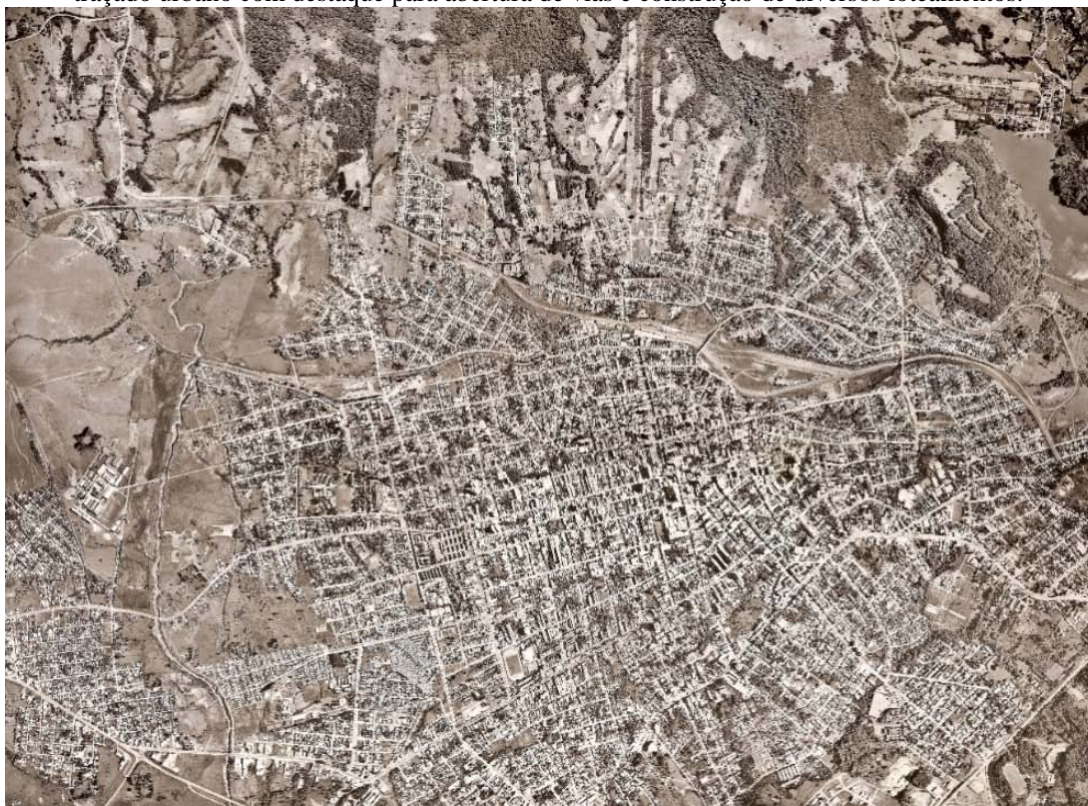
Figura 8 – Mosaico organizado a partir de 12 fotografias aéreas na escala 1:10.000, referente a voo realizado em 1992. Na imagem, através da fotointerpretação, identificou-se o andamento das obras de canalização do arroio Cadena e de retificação do canal principal. Também identificou-se áreas de extração de argila e cavas abandonadas, bem como um traçado urbano com destaque para abertura de vias e construção de diversos loteamentos.
