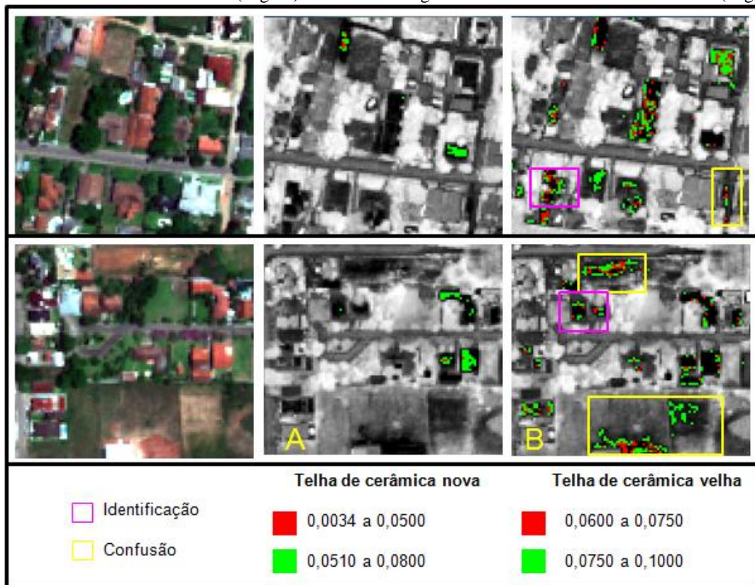
Figura 10 - Duas amostras de áreas diferentes com composição colorida GeoEye-1 (R3-G2-B1) a esquerda, imagem SAM das telhas de cerâmica nova (ângulo) ao centro e imagem SAM das telhas de cerâmica velha (ângulo).
