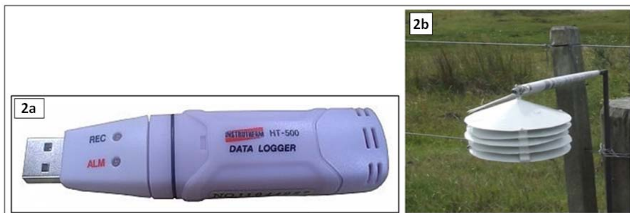
Figura 2b – Miniabrigo meteorológico de baixo custo.
