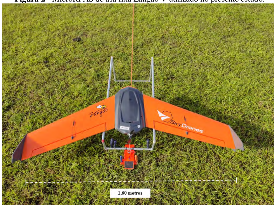
Figura 2 - MicroRPAS de asa fixa Zangão V utilizado no presente estudo.
