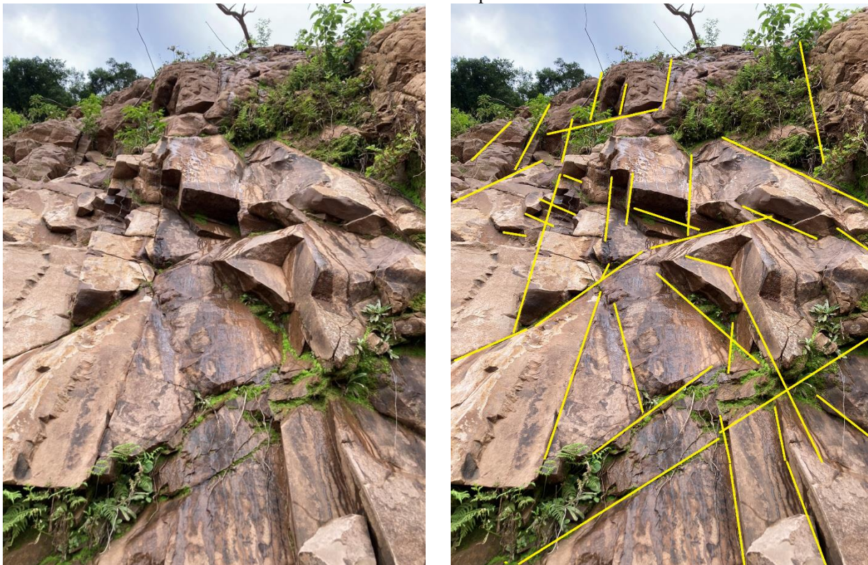
Figura 14 - Visão da zona de transporte do debris avalanche onde a erosão expôs do maciço rochoso do derrame vulcânico (riodacito) com diaclases verticais e oblíquas apresentando surgências de água que demonstram a forte influência do fluxo das águas subterrâneas percolando em fraturas na rocha.
