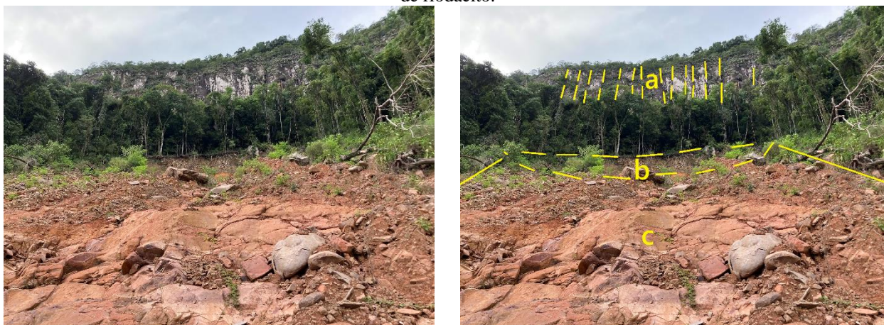
Figura 13 - Visão de uma cicatriz de deslizamento em Bento Gonçalves (Rua São Paulo, Divisa com Pinto Bandeira). Na porção superior, atrás da mata, observa-se (a) a escarpa rochosa de um derrame de riodacito apresentando diaclases verticais. Na porção média está (b) o local da ruptura no maciço rochoso fraturado ( Rock irregular slide ) e na porção inferior (c) a zona de transporte do debris avalanche onde a erosão expôs o maciço rochoso de um derrame mais antigo de riodacito.
